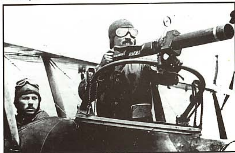
Der französische Flieger benutzt eine speziell konzipierte Kamera, um das Anvisieren eines Zielobjektes, im Visier des Maschinengewehres zu üben.
