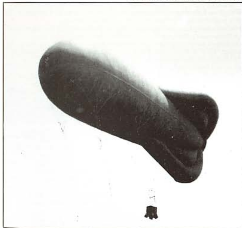
Ein mit Wasserstoff gefüllter, leichter-als-Luft Observations-Ballon der Engländer erhebt sich über Frankreich.
